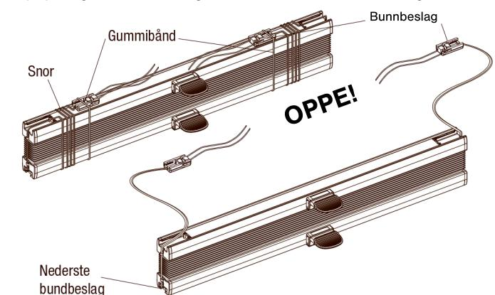
b) Skyv de øverste bunnbeslagene inn over monteringsplatene til de klikker på plass.
