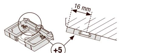
Profilens avstand til forkanten av vinduet skal være 5 mm (hullavstand 16 mm). Legg monteringsmalen ved markeringen "+5" ved forkanten.
