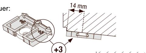
Profilens avstand til forkanten av vinduet skal være 3 mm (hullavstand 14 mm). Legg monteringsmalen ved markeringen "+3" ved forkanten.
